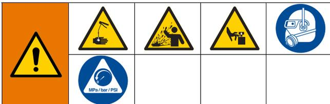
Это оборудование остается под давлением до тех пор, пока давление не будет сброшено вручную. Во избежание получения серьезной травмы, вызванной воздействием жидкости под давлением (например, в результате проникновения под кожу, разбрызгивания жидкости и контакта с движущимися деталями), выполняйте процедуру сброса давления после каждого завершения раздачи и перед очисткой, проверкой либо обслуживанием оборудования.
