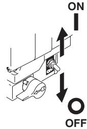
**Drain Valve / Válvula de drenagem / Vidange / Válvula de vaciado**
