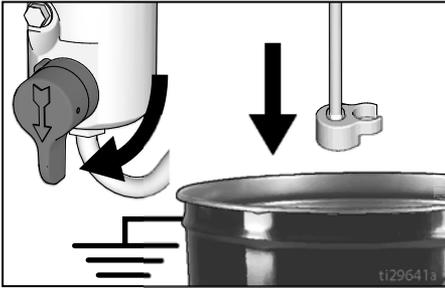
7. Si la buse ou le flexible de pulvérisation semble bouché(e) ou que la pression n'a pas été entièrement relâchée :
