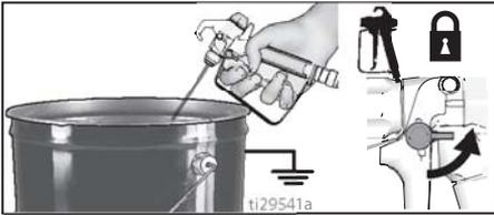
12. Tournez le bouton de commande de pression sur la pression minimale et mettez l'interrupteur MARCHE/ARRÊT sur la position **ARRÊT**. Débranchez l'alimentation électrique du pulvérisateur.
