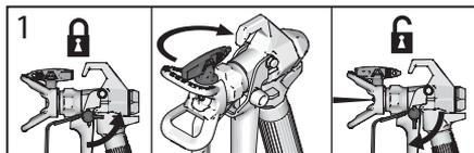
**REMARQUE :** Si la buse de pulvérisation est difficile à pivoter en tournant en position débouchage, suivez la **Procédure de décompression**, page 12, puis tournez la vanne d'amorçage/de pulvérisation en position pulvérisation et répétez l'étape 1.
