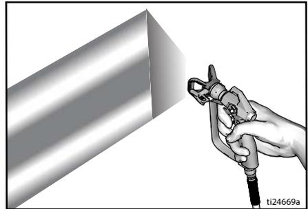
2. Prenez une buse de plus petit diamètre si le réglage de pression ne parvient pas à supprimer les bords trop chargés.
