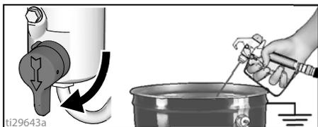
9. Relevez l'arrivée de fluide au-dessus du niveau de produit de rinçage.
