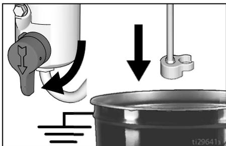
11. Placez l'arrivée de liquide et le tuyau de vidange dans un seau relié à la terre partiellement rempli de liquide de rinçage. Consultez **Mise à la terre**, page 11.
