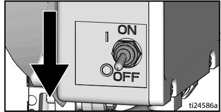
9. Branchez l'alimentation électrique sur une prise électrique correctement raccordée à la terre.
