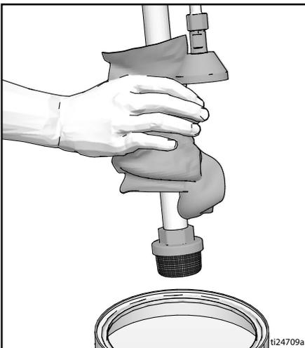
4. Plongez l'arrivée de fluide dans le produit de rinçage. Utilisez de l'eau pour une peinture à base aqueuse et du White Spirit pour une peinture à l'huile. Mettez le tuyau de vidange dans un seau à déchets.
