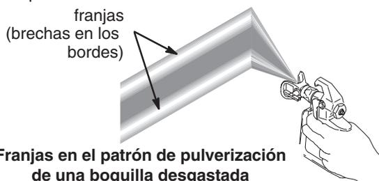
Para extender la vida útil de la boquilla, aplique el material a la menor presión que atomiza la pintura. Al aumentar la presión, el pulverizador desperdicia pintura y aumenta el desgaste de sus componentes. Reemplace la boquilla cuando esté desgastada.
