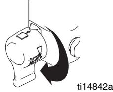
10. Coloque la bomba en un bidón metálico parcialmente lleno con líquido de lavado. Fije el cable de conexión a tierra en el bidón y a una tierra verdadera. Efectúe los pasos 1 a 5 de la **Puesta en marcha** para eliminar por lavado el aceite de almacenamiento enviado en el pulverizador. Use agua para lavar las pinturas a base de agua y alcohol mineral para las pinturas a base de aceite y el aceite de almacenamiento.
