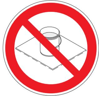
**Siempre conecte a tierra un balde de metal:** conecte un cable de puesta a tierra al balde. Conecte un extremo al balde y el otro a una puesta a tierra verdadera, tal como una tubería de agua.
