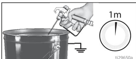
8. Apunte la pistola hacia el bidón de pintura y dispárela durante 20 segundos. Suelte el gatillo y permita que el pulverizador acumule presión. Acople el seguro del gatillo.
