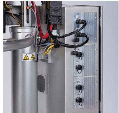
Seis puntos de conexión para las 12 zonas de calentamiento definidas por el cliente
