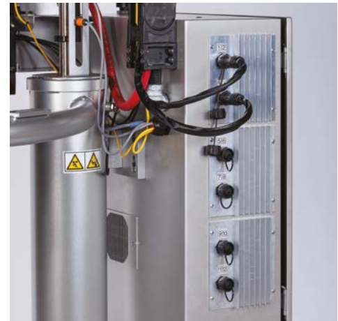
Six points de raccordement destinés aux douze zones de chauffe définies par le client
