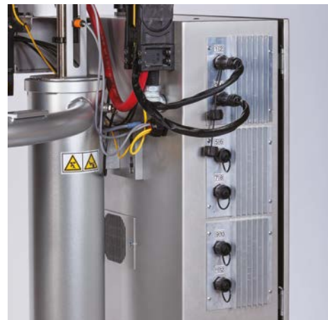
Sei punti di connessione per le 12 zone riscaldate definite dal cliente
