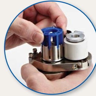
Remplacer par une nouvelle cartouche de lames
