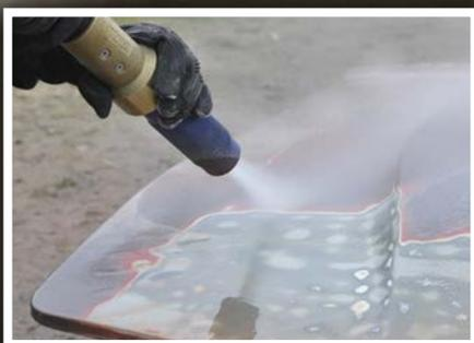
Rimozione di vernice e rivestimenti
