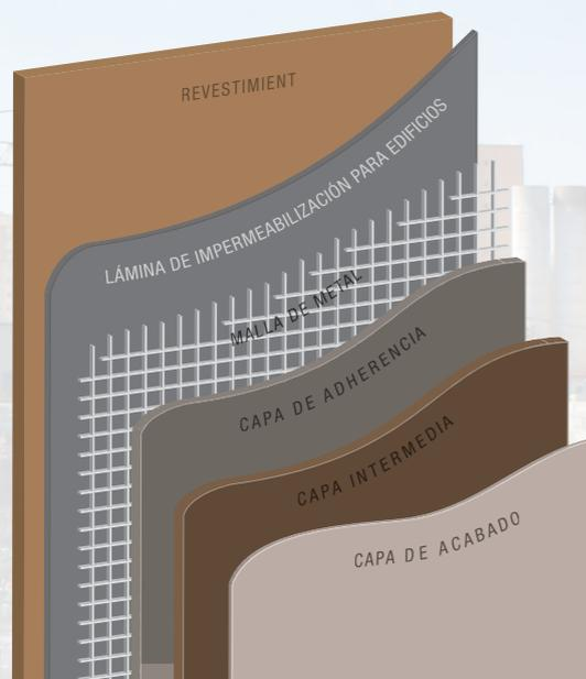
Para aplicaciones de estuco, la bomba para estuco ToughTek S340e maneja la capa de adherencia, la capa intermedia y la capa de acabado.
