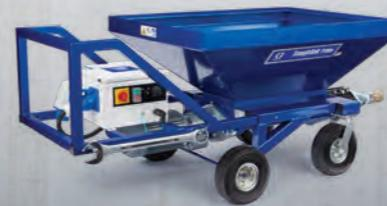
BOMBA DE ESTATOR/ROTOR
