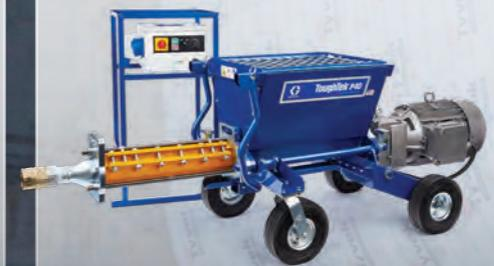
BOMBA DE ESTATOR/ROTOR
