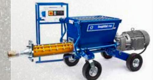
ROTOR STATOR PUMP
