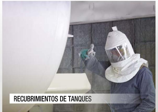
RECUBRIMIENTOS DE TANQUES
