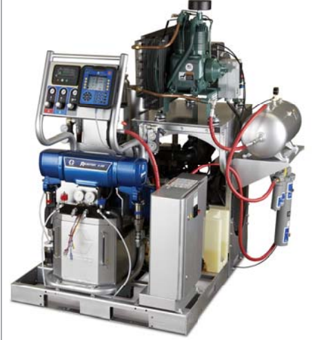
Şekil 1 – Entegre Reaktör sistemi, opsiyonel hava kompresörü ile görülmektedir
