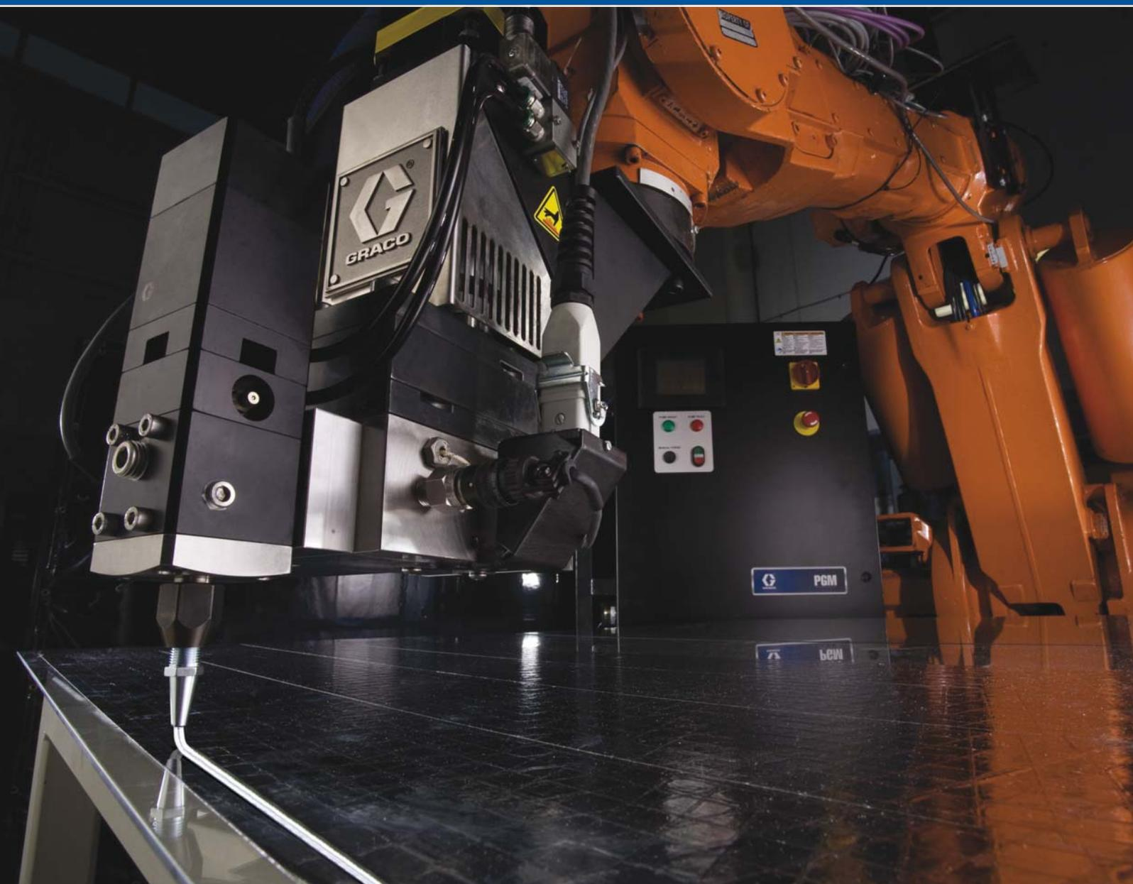
**Assure un dosage précis et un contrôle final permettant de déposer un cordon ou un ruban lisse et uniforme**
