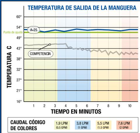
El reactor A-25 mantiene los ajustes de temperatura continuamente, incluso cuando esté pulverizando al caudal máximo, lo que se traduce en una espuma de mejor calidad. Las temperaturas del modelo de la competencia fluctuaron conforme el caudal aumentaba.
