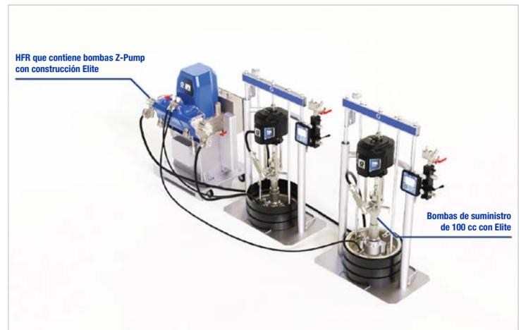
Configuración del sistema para pruebas de dispensación de Bondway bicomponente
