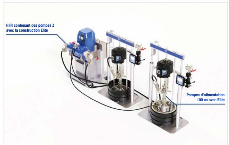
Configuration du système pour le test de distribution Bondway à deux composants
