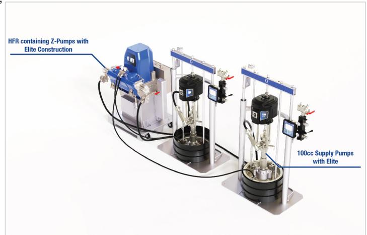
Bondway 2액형 디스펜스 테스트를 위한 시스템 구성
