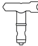
DIE DÜSE BESTIMMT DEN SPRITZWINKEL UND DIE MATERIALMENGE
