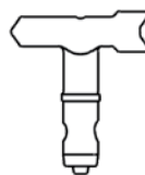
L'UGELLO DETERMINA L'ANGOLO E LA PORTATA DI SPRUZZATURA
