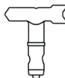
DE SPUITTIP BEPAALT DE SPUITHOEK EN DE SPUITUITVOER
