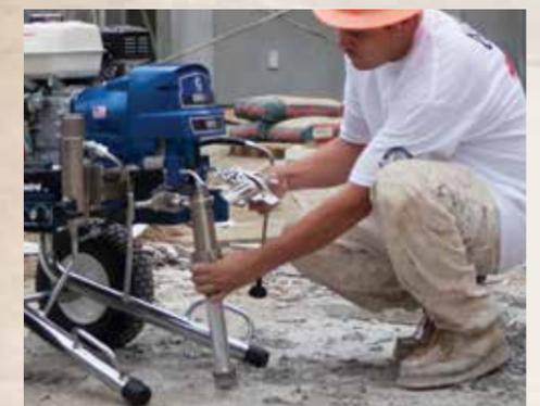
**ProConnect™ 2** Esse design sem pinos de última geração do sistema de instalação e remoção de bombas ProConnect da Graco torna mais fácil e rápido do que nunca substituir a bomba, em questão de segundos.
