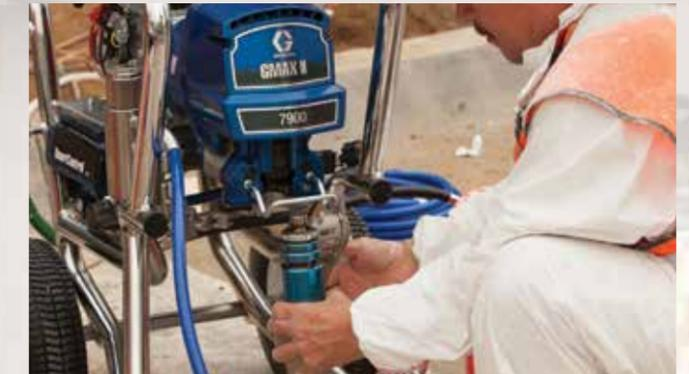
**ProConnect 2** Esse design sem pino de última geração do sistema de remoção e instalação de bombas da Graco torna mais fácil e rápido do que nunca substituir a bomba, em questão de segundos.
