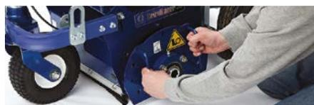
2. Schrauben und Abdeckung entfernen
