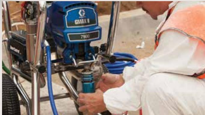
**ProConnect 2** Este diseño de próxima generación sin clavijas del Sistema de extracción e instalación de bomba ProConnect de Graco hace que sea más fácil y rápido que nunca sustituir la bomba en cuestión de segundos.
