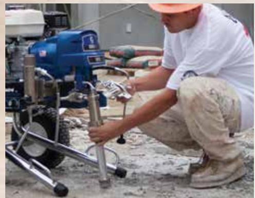
**ProConnect™ 2** Este diseño de próxima generación sin clavijas del Sistema de extracción e instalación de bomba ProConnect de Graco hace que sea más fácil y rápido que nunca sustituir la bomba en cuestión de segundos.
