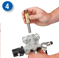
新しいカートリッジにし、ポンプ交換
