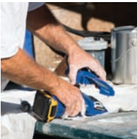
2. スプレーヤーから古いポンプを取り出します。
