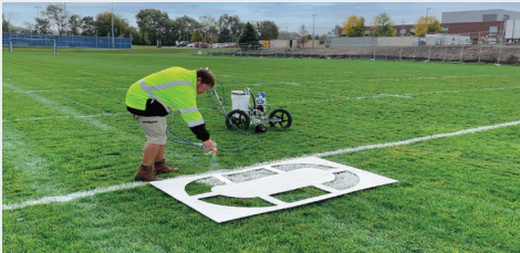
Extracción de pistola sin herramientas para plantillas de rociado o áreas sólidas y grandes.
