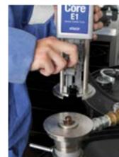
3. Deslizar el motor eléctrico para sacarlo
