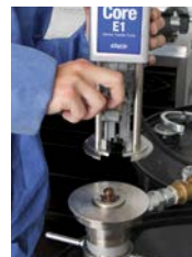
3. 電気モーターをスライドさせて外します
