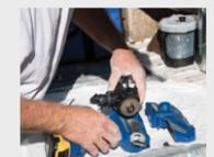
3) Coloque la bomba nueva en el pulverizador.
