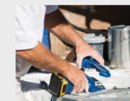
2) Retire la bomba anterior del pulverizador.
