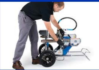
1) 固定クランプと圧力トランシスデューサー接続を取り外します。
