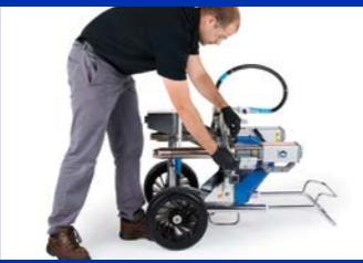
1) 拆卸固定卡箍与压力传感器连接件
