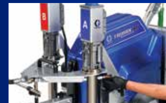
1) Retire las abrazaderas de sujeción y las conexiones del transductor de presión
