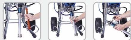
Desserrer l'écrou de serrage
