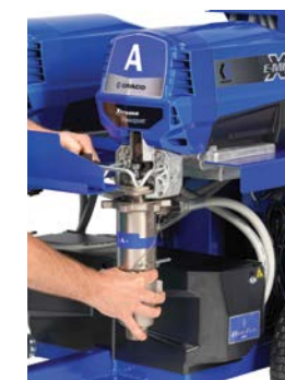
2. 打开泵门并卸下泵
