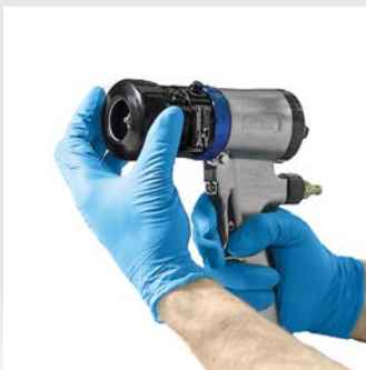
Haltering und Luftkappe entfernen.
