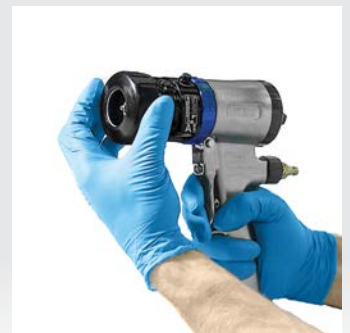
Luftkappe und Haltering installieren.
