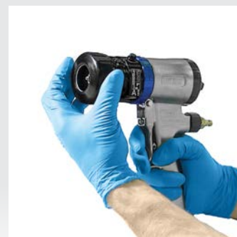
Montare il cappello dell'aria e l'anello d'arresto
