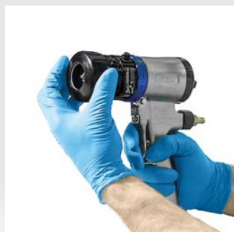
Rimuovere il cappello dell'aria e l'anello d'arresto
