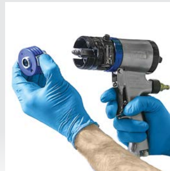
Yeni PC akışkan kartuşunu karıştırma bölmesine takıp bastırın
