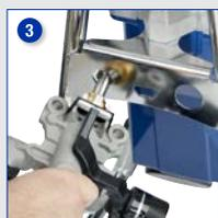
3 Utilisez le raccord hexagonal du châssis pour desserrer la pompe et enlever la cartouche
