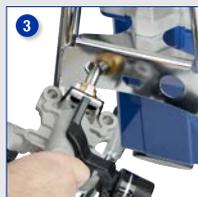
Utilisez le raccord hexagonal du châssis pour desserrer la pompe et retirer la cartouche
