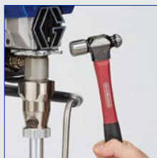
Ослабить зажимную гайку
