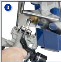
Pompayı gevşetmek ve kartuşu çıkarmak için çerçeve altıgen bağlantı elemanı kullanın
