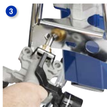
3 S šestkotnim fittingom za okvir odvijte črpalko in odstranite zbiralnik
