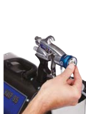
1. Verwijder de luchtkap en spuitpunt aan de voorzijde.
