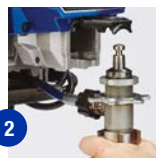
2 Åpne pumpedekselet og fjern pumpen
