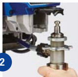
2 Abra a porta e retire a bomba
