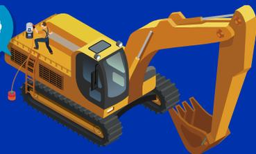
Bei sehr großen Maschinen steigt der Bediener zum Nachfüllen üblicherweise **mit einem Schlauch auf eine Leiter oder eine Treppe**, um diesen an den Behälter anzuschließen. Mit dem Schlauch in der einen Hand hat der Bediener dann nur noch die andere Hand frei und verliert damit den Kontakt mit mindestens drei Punkten, die zum sicheren Erreichen des Behälters eigentlich hergestellt werden sollten.
