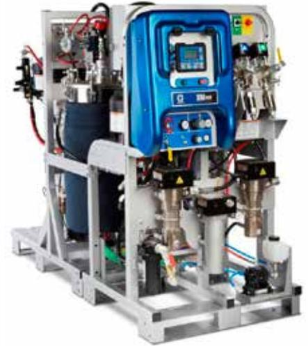
*Los pulverizadores de aplicación multicomponente XM™ PFP de Graco emplean la dosificación de inyección continua para un control preciso de la relación de mezcla.*
